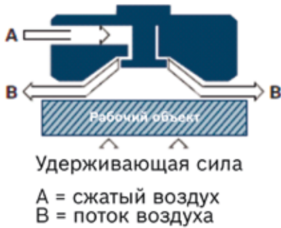
Захват объектов основан на принципе Бернулли
