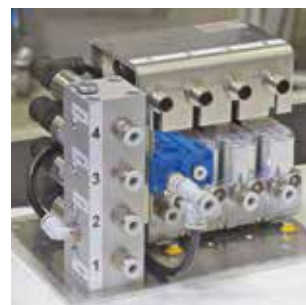
Компактная электронно-пневматическая регуляция с аналоговым считыванием для печатной промышленности
